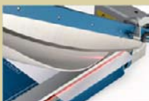
Indicación de corte por medio de rayo láser
